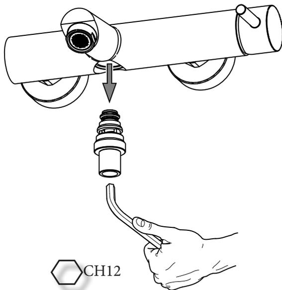
**d** Sostituzione Aeratore
