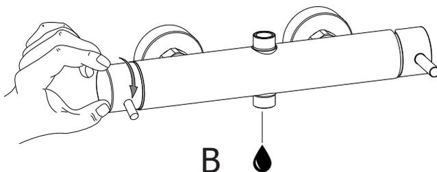
Cambiando la selezione dell'uscita si verifica uno sgocciolamento da entrambe le uscite come sicurezza, al fine di non dimenticare il miscelatore aperto ed evitare di esporre il deviatore a pressioni non idonee.
